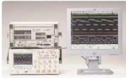
Рисунок 8 - Осциллограф серии 6000 с подключенным внешним монитором
