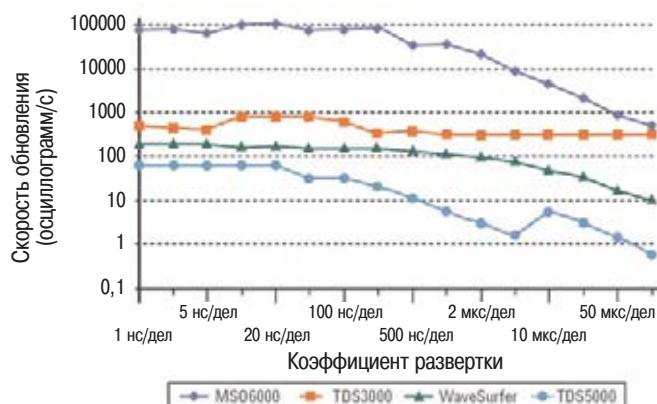
**Рисунок 6 - Сравнение скоростей обновления осциллограмм при использовании в каждом осциллографе реальноревременного режима сбора данных, устанавливаемого по умолчанию**
