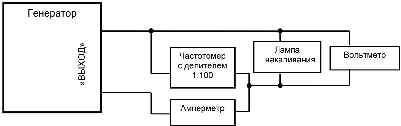
Рисунок 9.5.3 - Схема рабочего места для проверки параметров генератора
